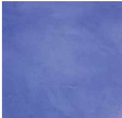
Béton ciré millimétrique teinté bleu.
