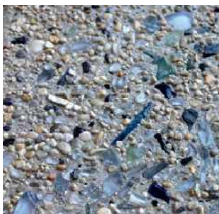
Béton lavé intégrant des granulats naturels et des granulats de verre incrustés.
