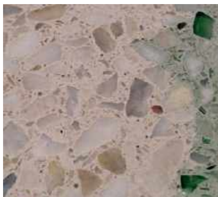
Béton poli comprenant dans la masse des granulats de verre.
