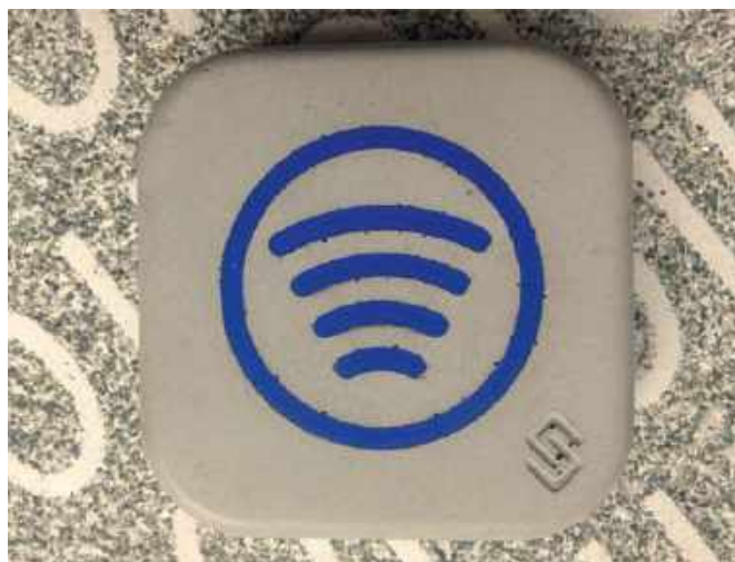
Béton connecté. La matière devient interactive. En intégrant des capteurs l'objet en béton devient réceptacle ou diffuseur d'information.
